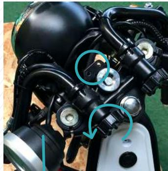
**2** - Votre tableau de bord se fixe dans le cercle, comme présenté dans l'illustration ci-contre. Commencez par dévisser la vis du guidon pliable, pour le déplier, puis positionner le tableau de bord sur le cadre, à l'endroit indiqué.
