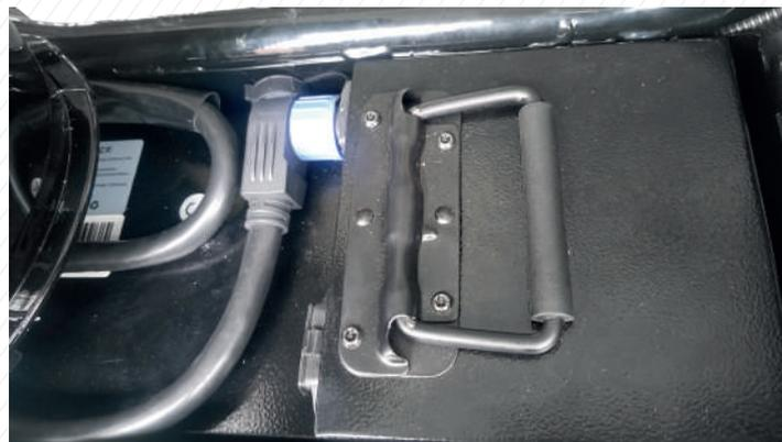
**b.** Débranchez la prise de chargement (Tournez la bague bleue) puis sortez la batterie du scooter à l'aide de la poignée.
