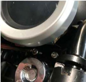
**3** - Avec une main positionnez le premier écrou sous la languette du cadre qui accueillera le tableau de bord. Avec votre autre main, passez la vis à travers la languette du tableau de bord. Alignez l'ensemble puis commencez à visser avec la clé BTR tout en maintenant l'écrou avec vos doigts.
